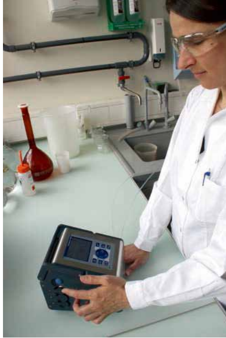
ORBISPHERE 3100 분석기는 실험실에서 사용합니다. 분석기는 실험실과 공정에서 모두 사용할 수 있습니다.
